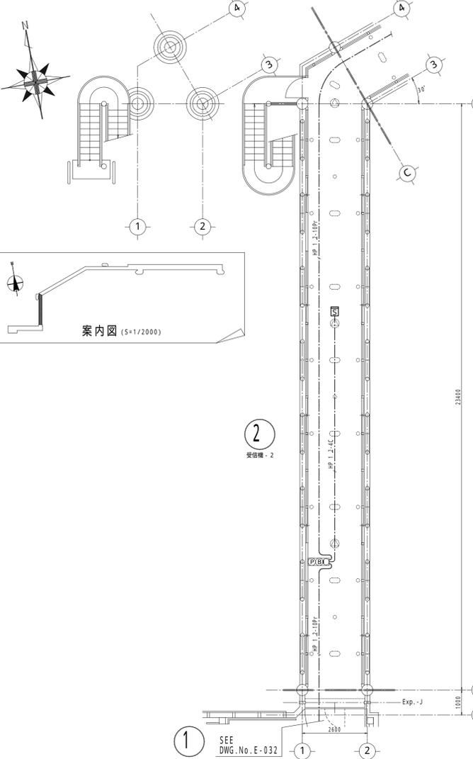
2 自動火災報知設備 配線図 1/100 歩廊橋平面図-2
