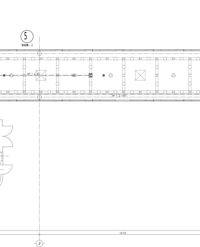
6 自動火災報知設備 配線図 1/100 客溜り平面図
