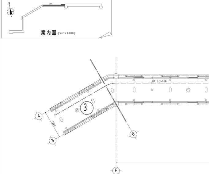
4 自動火災報知設備 配線図 1/100 客溜り平面図
