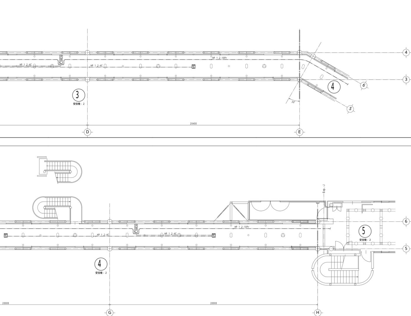
7 自動火災報知設備 配線図 1/100 客溜り平面図
