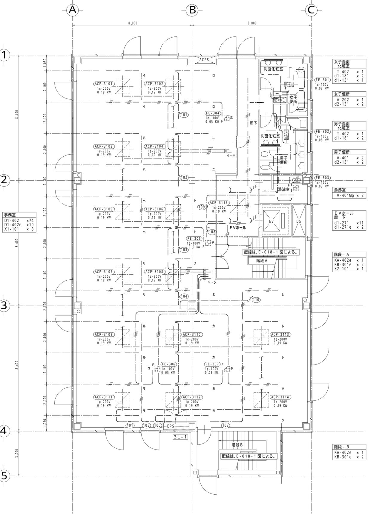
2 屋階 配線図 (照明・換気設備) 1/100
